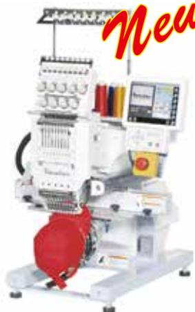
大型タッチパネル式LCD搭載により、視認性・操作性が大幅に向上しました。サーボモーター採用により、多頭式刺繍機と同等の高いステッチ精度及び更なる高生産効率を実現しました。
